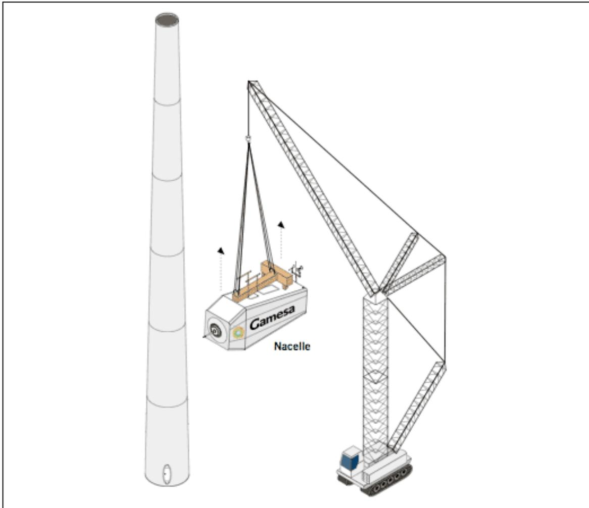
Figura II-21. Montaje de la nacelle.
