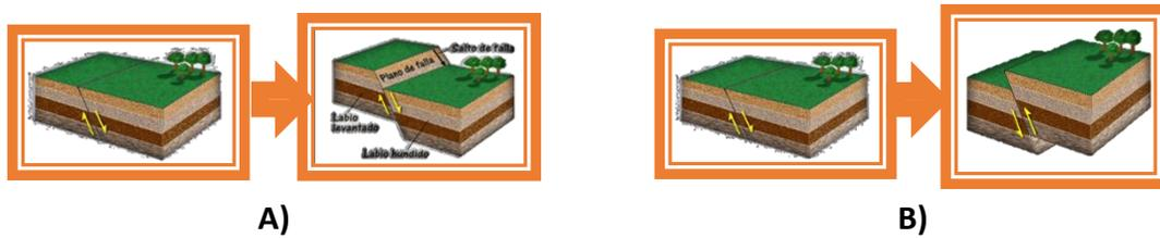
Figura 40. Desplazamiento de las fallas de A) Tipo normal y B) Tipo Inversa
