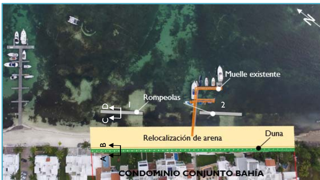
Figura II_ 2. Plano general de obras del proyecto.
