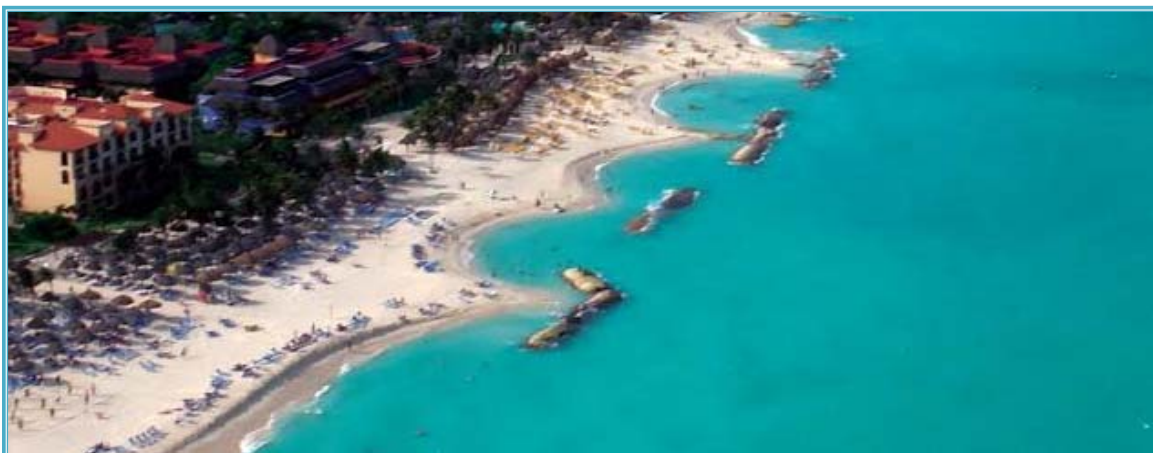
Figura II_ 15. Ejemplo de rompeolas paralelos a la línea de costa.
