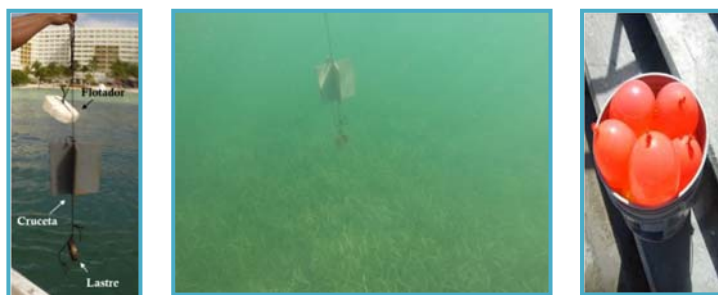
Figura IV_ 15.- Fotos de crucetas de deriva y globos rellenos con agua usados en las mediciones de las corrientes.
