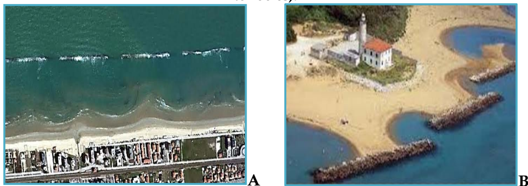
Figura 12 continuación. Ejemplos de respuesta de playa con rompeolas paralelos (A Salientes, B tómbolos).
