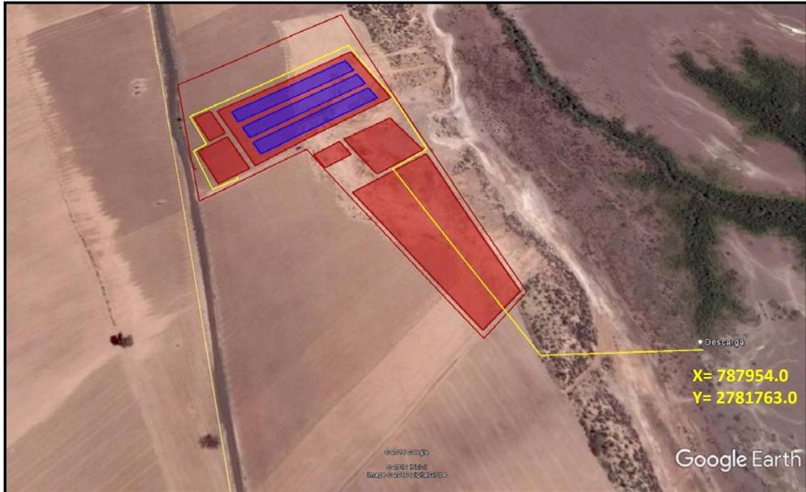
Figura II.6. Punto de descarga de aguas residuales y tuberías de 8 pulg de descarga, Polígono (■), tubería de descarga de AR (—)
