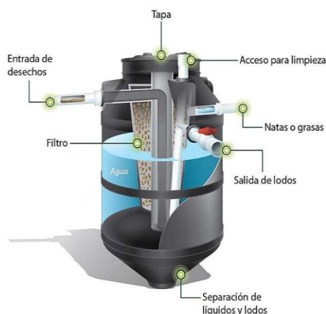
Figura 2.13 Funcionamiento del biodigestor.
