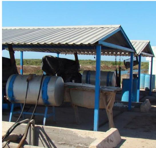
**Figura 6.11** Modelo análogo para sardineles y techumbre para protección de carcamo de bombeo.
