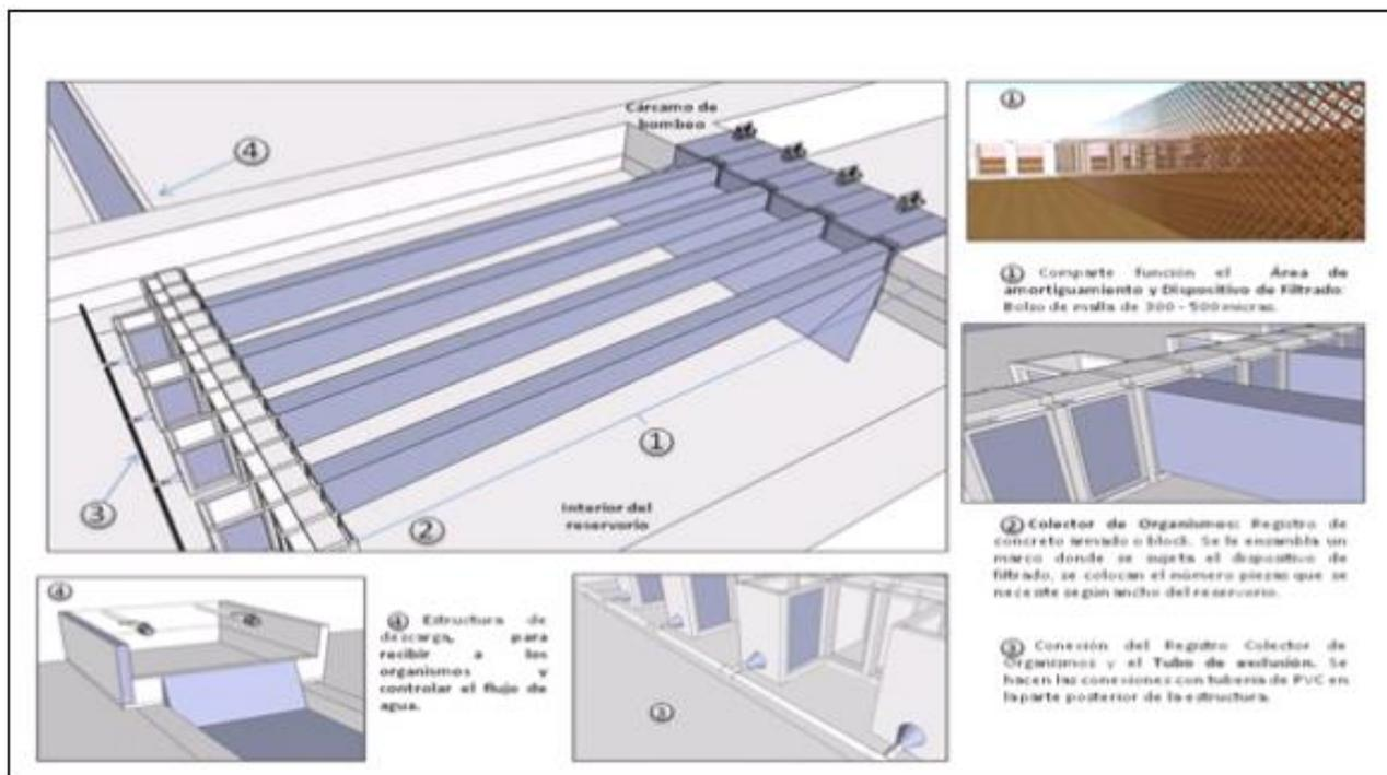
Figura: Esquema general del SEFA-4 que consiste en la colocación de compuertas y bastidores con registros excluidores.
