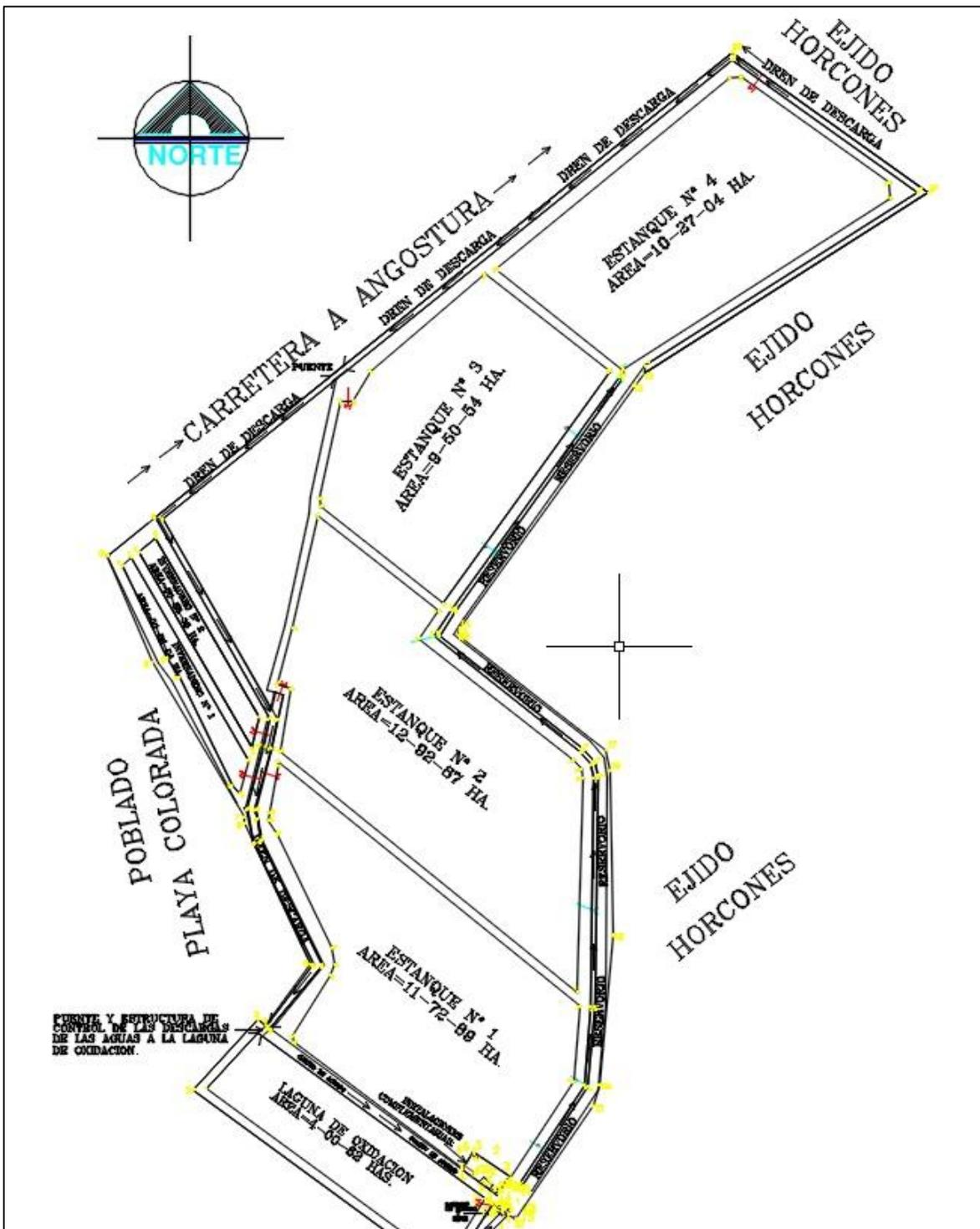
b) Estanques para preengorda, engorda, aclimatación y manejo sanitario, canal de abastecimiento, dren de descarga, canales de distribución y cárcamo de bombeo.
