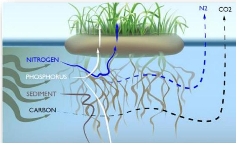
Figura 5. Esquema de funcionamiento de chinampas depuradoras. (Yeh, N. Et al. 2015)
