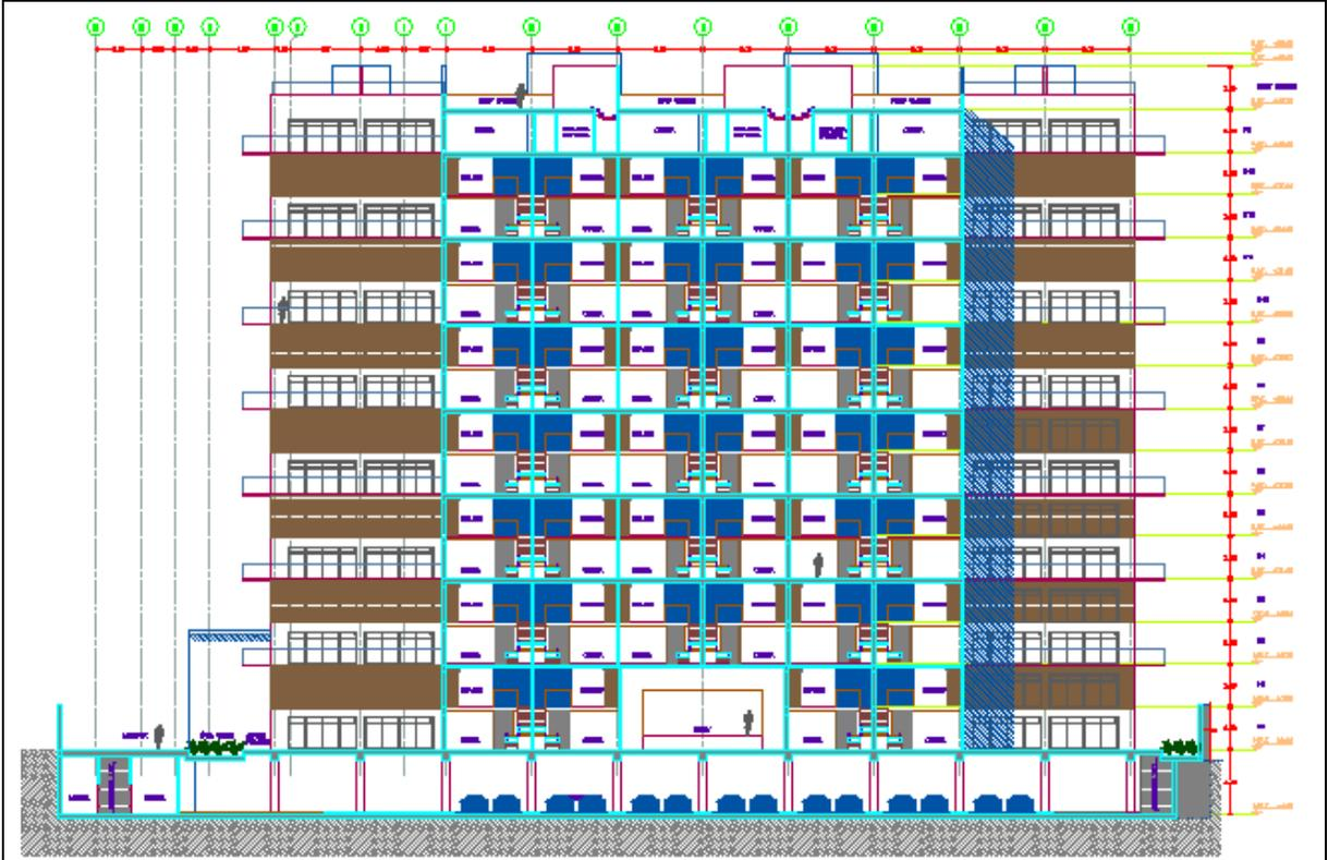
FIGURA 7. PLANO CORTE TORRE B DE SUR A NORTE SE OBSERVA ESTACIONAMIENTO SUBTERRANEO.
