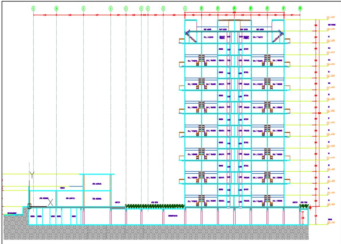
FIGURA 8. PLANO CORTE TORRE B DE ESTE A OESTE SE OBSERVA ESTACIONAMIENTO SUBTERRANEO.
