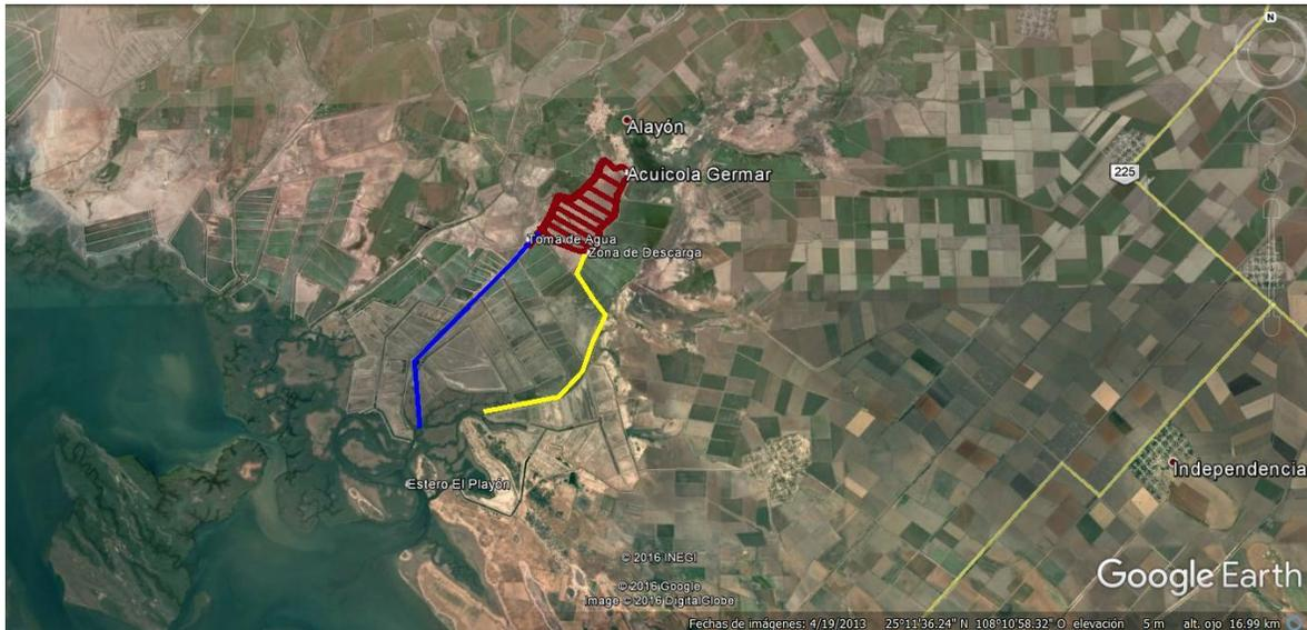
**Figura.** La línea azul corresponde al canal de llamada existente, y en amarillo al canal de descarga.
