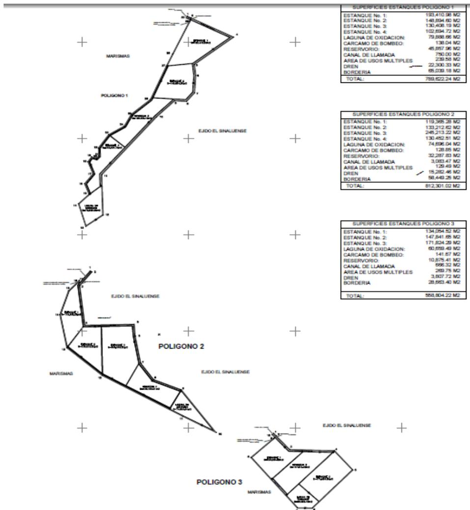
b) Estanques para preengorda, engorda, aclimatación y manejo sanitario, canal de abastecimiento, dren de descarga, canales de distribución y cárcamo de bombeo.
