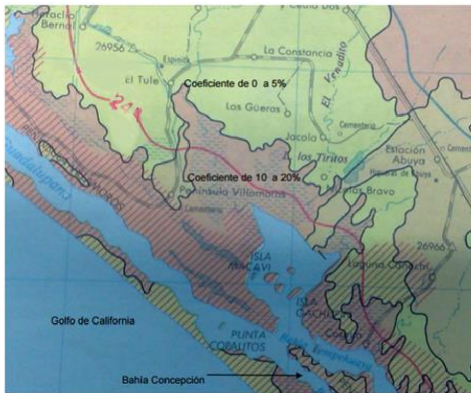
Coeficientes de escurrimiento en la subcuenca "F"
