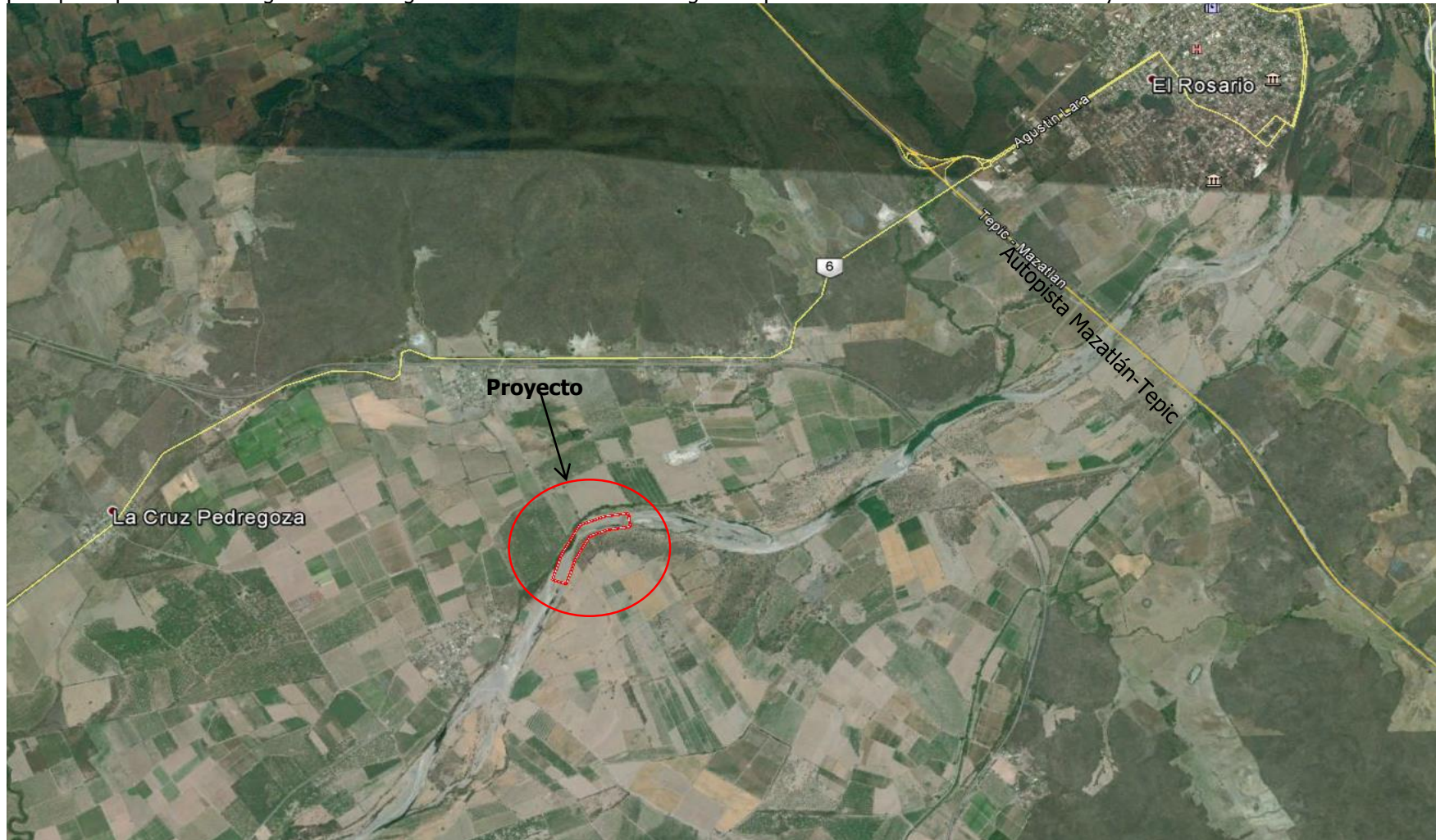
Figura 19.- Determinación y Caracterización gráfica del sistema ambiental predial donde se localiza el proyecto. Corresponde al lecho del Rio Baluarte, a 3,929 metros aguas abajo del puente de la Autopista MAZATLÁN-TEPIC, municipio de El Rosario, Sinaloa y se pretende de acuerdo a la CONAGUA, la rectificación del cauce, con el retiro del meandro de azolve acumulado por años, devolviendo al eje del escurrimiento principal capacidad hidrológica acorde al gasto del Rio evitando la divagación que hace errática la huella de su trayectoria.
