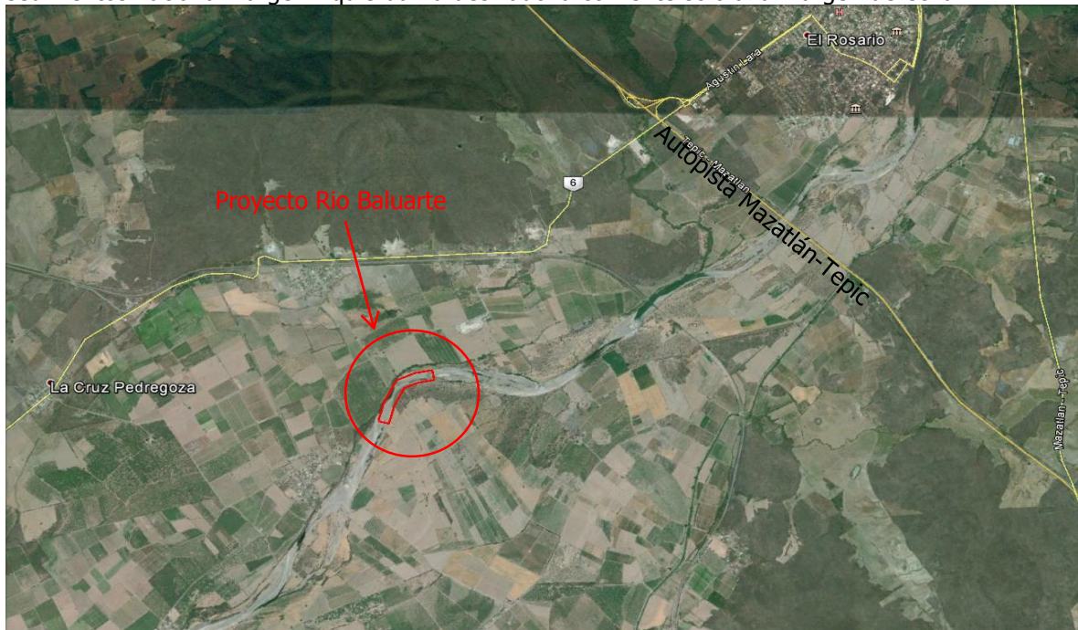
Figura 20.- Apreciación del proyecto dentro del Rio Baluarte. El meandro formado por acarreo de sedimentos hacia la margen izquierda ha desviado la corriente solo a la margen derecha.
