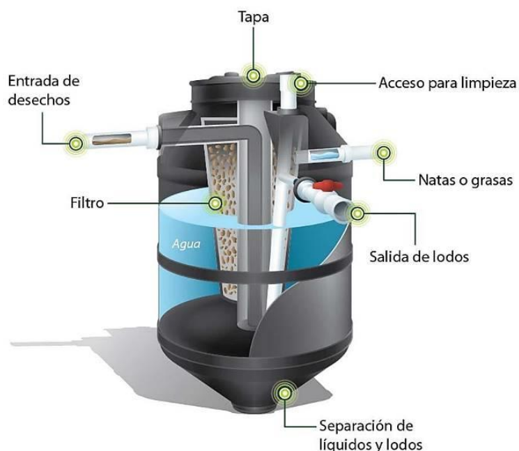
Figura 2.6 Operación del Biodigestor
