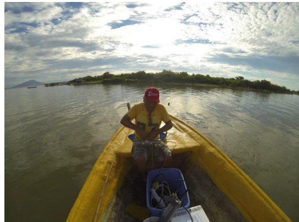
Figura IV.13.- Armado de botella Van Dorn para la toma de muestras de agua.
