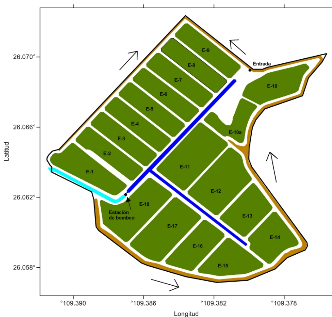
Figura II.1. Distribución de estanques (■), canal de llamada (—), reservorio (—), drenes (—) y flujo de agua (→) en la sección en operación de JM Acuacultura SA de CV sección Marion
