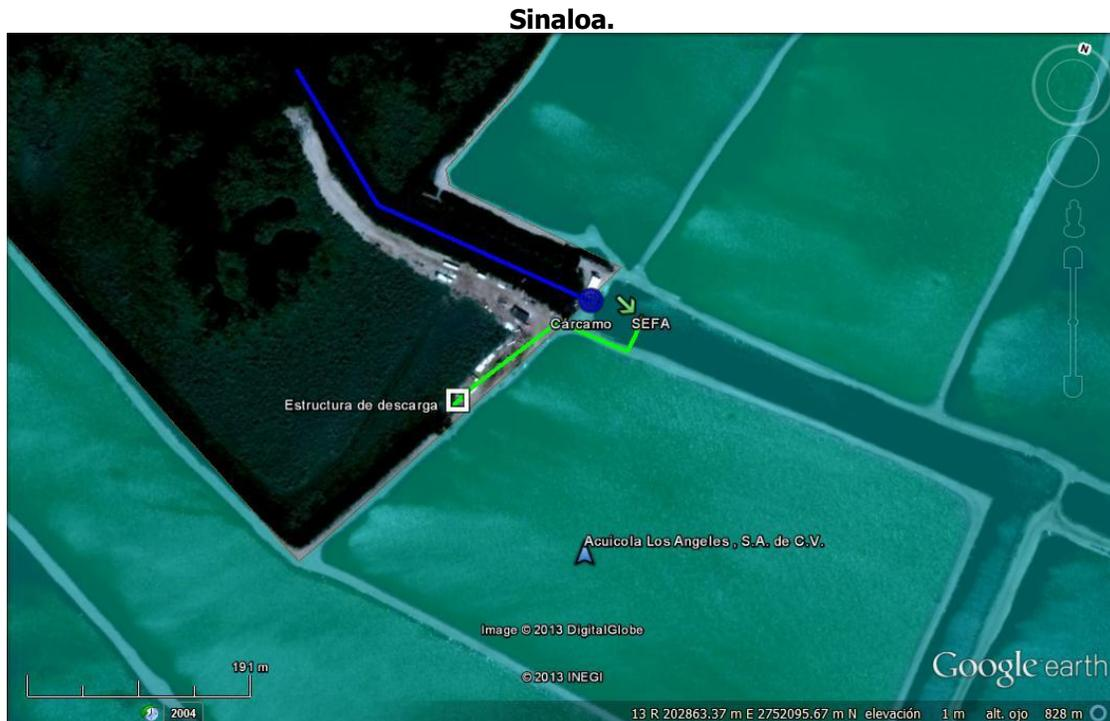
Imagen de satélite que muestra la ubicación de la unidad de producción acuícola de cultivo de camarón Acuícola Los Ángeles S.A. de C.V., los estanques, el canal de llamada (azul) y el tubería de exclusión y SEFA (verde): a) ubicación global y b) detalle de la unidad de producción acuícola de cultivo de camarón. Fuente: Google Earth.
