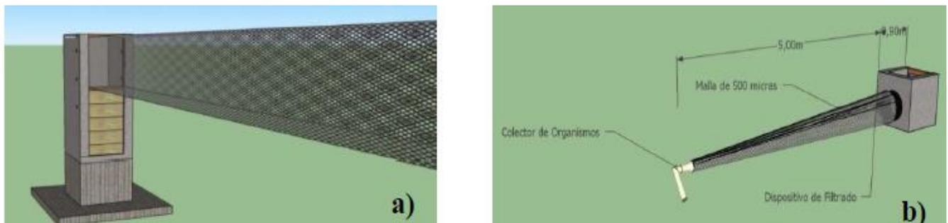
**Figura 2.8** Diagrama dispositivo de filtrado y colector de organismos del SEFA.
