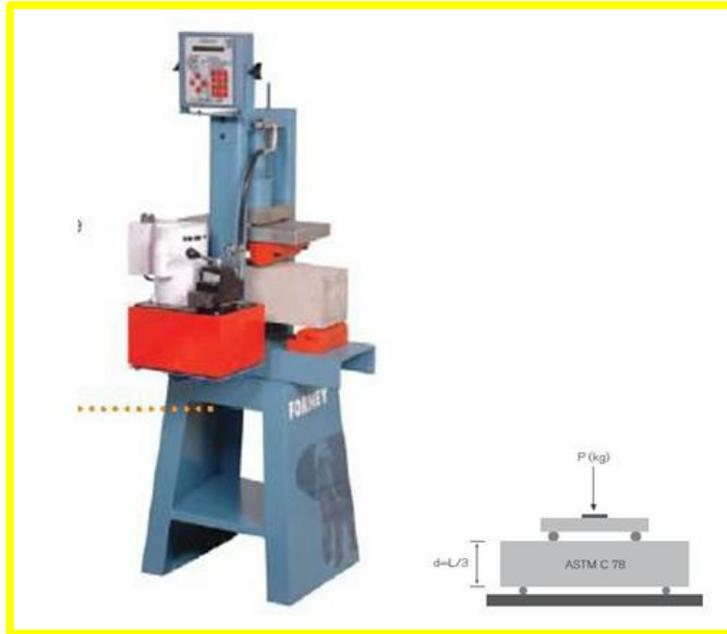
**Fig. II.12.-** Máquina de ensayo para el control de calidad de la determinación del módulo de ruptura, efectuado con ensaye de vigas a la flexión.
