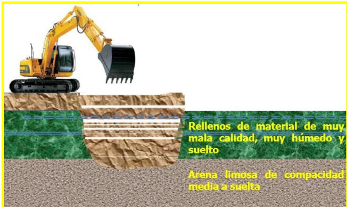
**Fig. II.10.-** Se rellenará y colocará un piedraplén con tamaño de rocas de 6 a 20 pulgadas que se rellenará hasta tener una altura de 1.0 m arriba del nivel freático.
