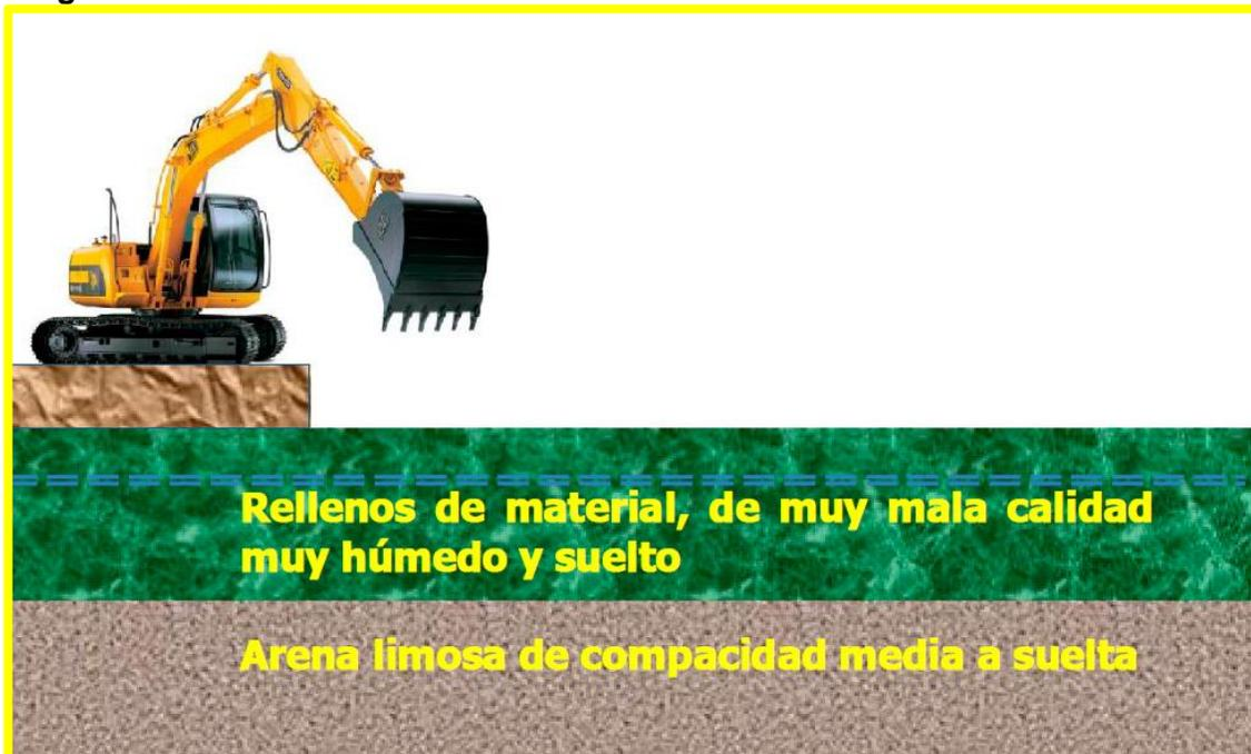
Fig. II.8.- Colocar un piedraplén de 50 cm de espesor mínimo, constituido por boleos de río o material de explotación de cerro de roca sana, sin finos, con tamaño nominal, entre 6 a 12 pulgadas, esto es para iniciar y para que pueda entrar el equipo.
