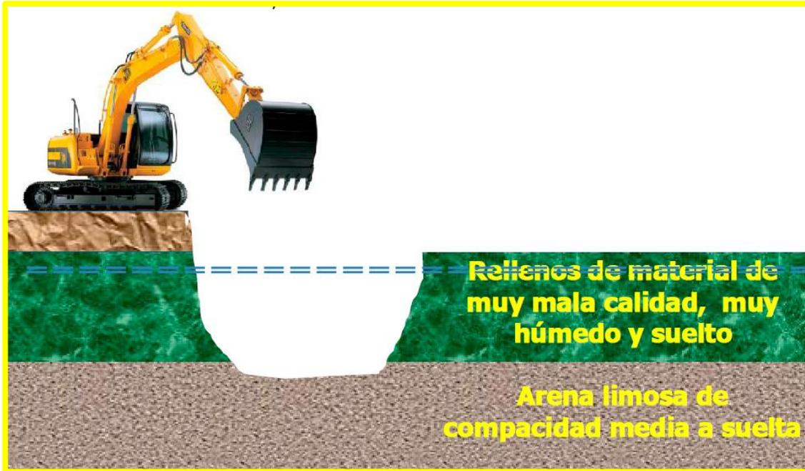
**Fig. II.9.-** Con el piedraplén, se introducirá una máquina retro-excavadora, que excavará y retirará el material de mala calidad, hasta su alcance máximo.
