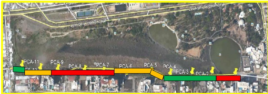
**Fig. II.6.-** Zonificación de los espesores de enrocamiento.
