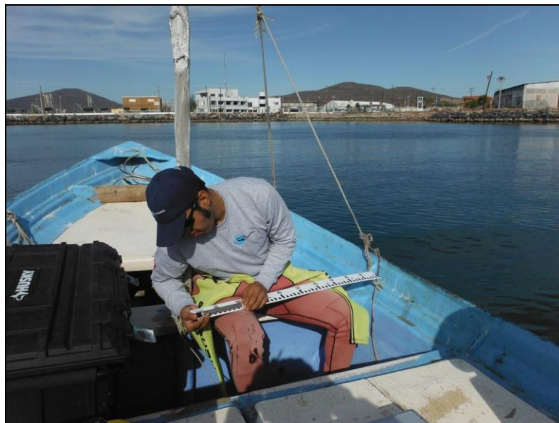
Fotografía IV.5.- Regla de Marea para medición del nivel del mar.
