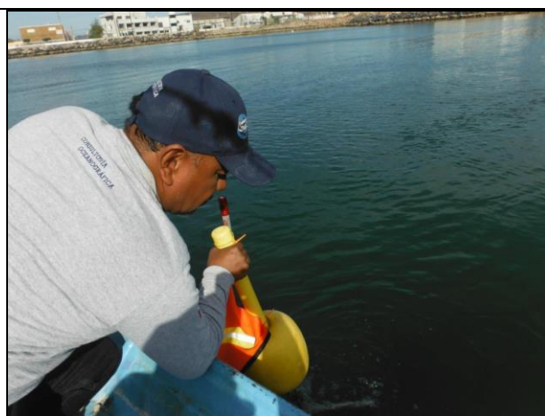
Fotografía IV.4.- Estimación de la dirección de corriente superficial (método lagrangiano).
