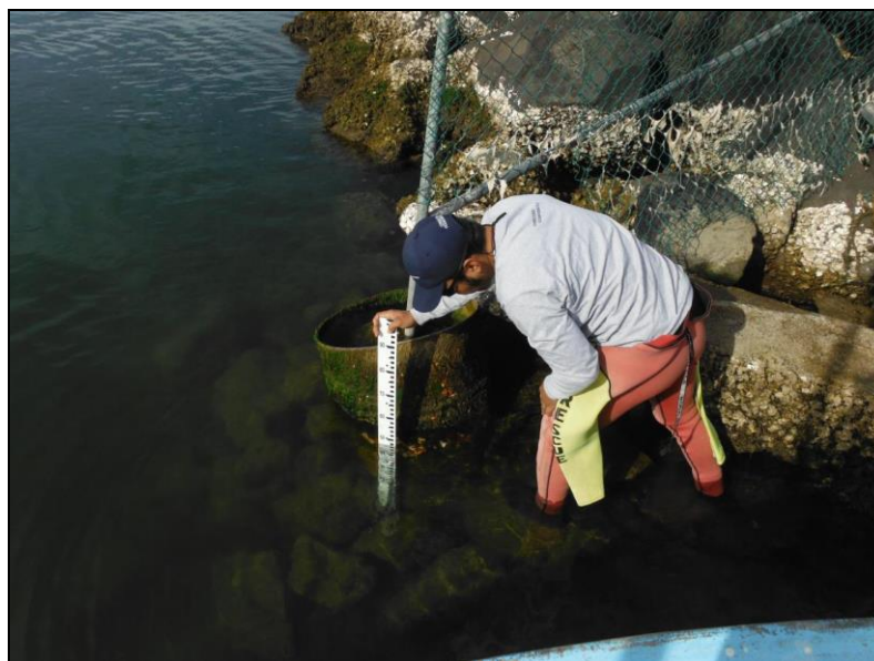
Fotografía IV.6.- Sensor de presión para medición de marea.
