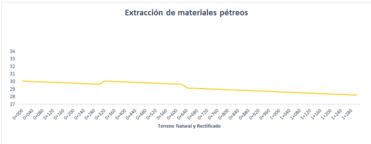
Grafica 02. Terreno rectificado del cauce del río Fuerte de la sección transversal 0+000 a la 1+300 con la eliminación de fosas y taponés de material pétreo que serán rectificadas dejando el eje del proyecto con una pendiente suave y una profundidad constante asegurando un poder de conducción importante al río Fuerte.
