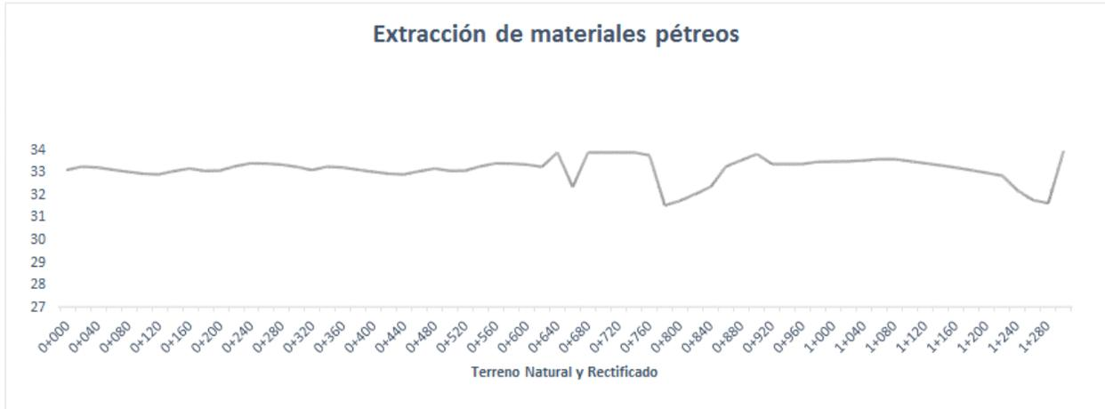
Grafica 01. Terreno natural del cauce del río Fuerte de la sección transversal 0+000 a la 1+300 con existencia de fosas y taponés de material pétreo que serán rectificadas dejando el eje del proyecto con una pendiente suave y una profundidad constante asegurando un poder de conducción importante al río Fuerte.
