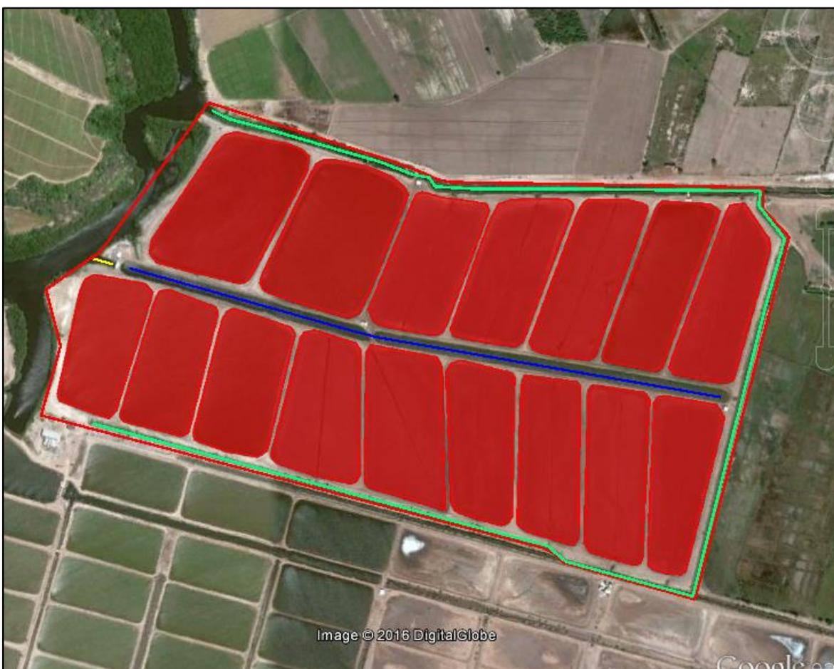
**Figura II.1.** Distribución de estanques ( ◆ ), canal de llamada ( — ), reservorio ( — ), drenes ( — ) y flujo de agua ( → ) en la granja Bioplanet SA de CV.
