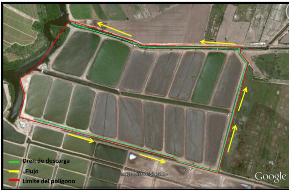
Figura II.8 Drenes con sus flujos y punto de descarga en la granja Acuícola Bioplanet S.A. de C.V.
