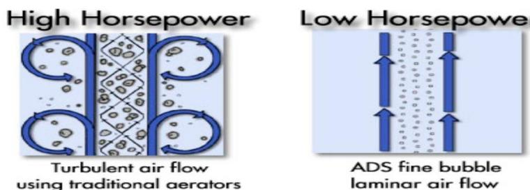
Figura VI.2. Ventajas del ADS sobre aireación convencional.
