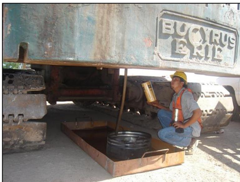
Imagen No. 22. Charolas metálicas a utilizar, con una medida de 1.5 de largo x 1.00 de ancho.
