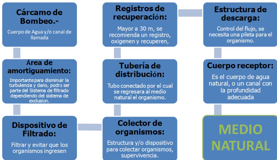
Los sistemas excluidores se dimensionan en función del gasto hidráulico de la granja.
