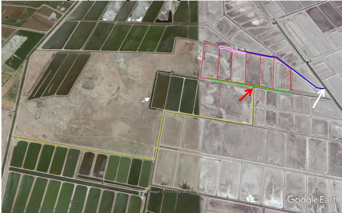
Diagrama de las obras de conducción de la granja acuícola. En color azul se indica el canal de llamada, la línea rosa fuerte representa el reservorio principal y la línea verde esquematiza el dren de descarga perimetral, mientras que la línea amarilla señala el trayecto que siguen las aguas residuales hasta su descarga al Dren El Burrión. La flecha blanca representa el sitio de toma y la flecha color rojo el punto de descarga. Magnificar imagen para ver detalles.
