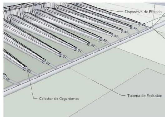
Figura 6.6 Diagrama tubería de exclusión del SEFA
