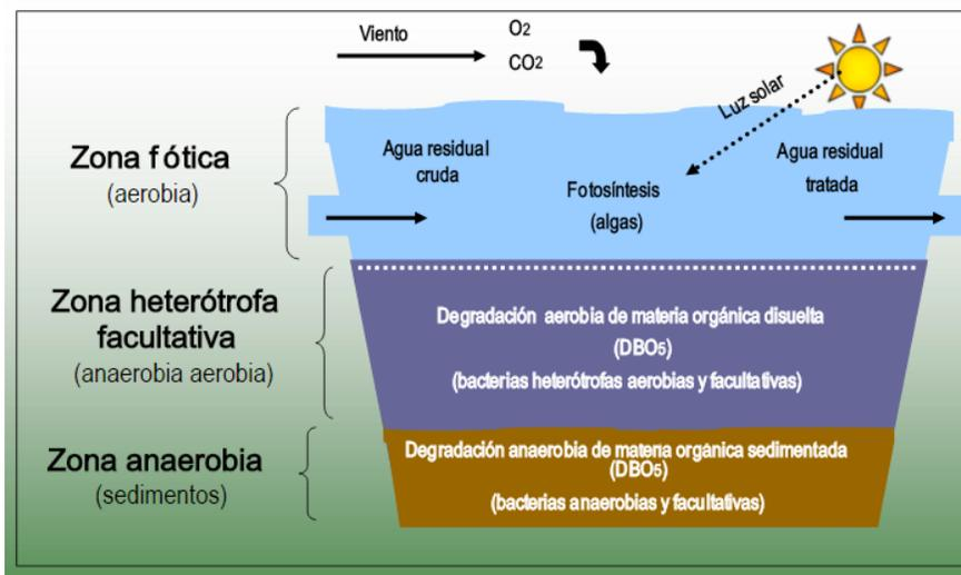
**Figura 6.8** Operación de la Laguna de Oxidación
