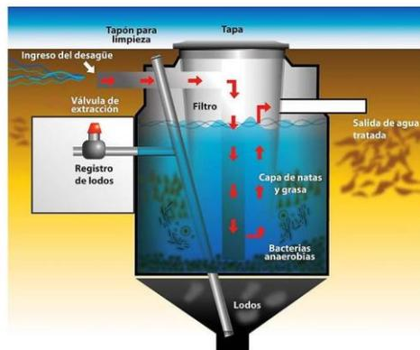
*Figura 2.14 Operación del Biodigestor*
