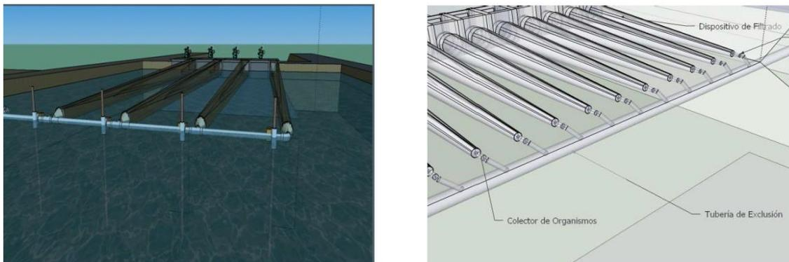
Figura 2.20 Diagrama tubería de exclusión del SEFA
