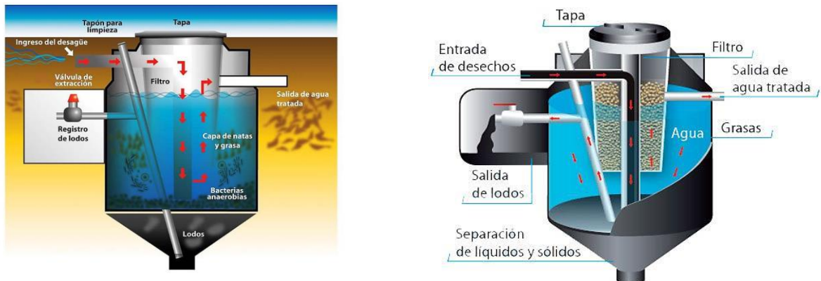
Figura 2.11 Funcionamiento del Biodigestor
