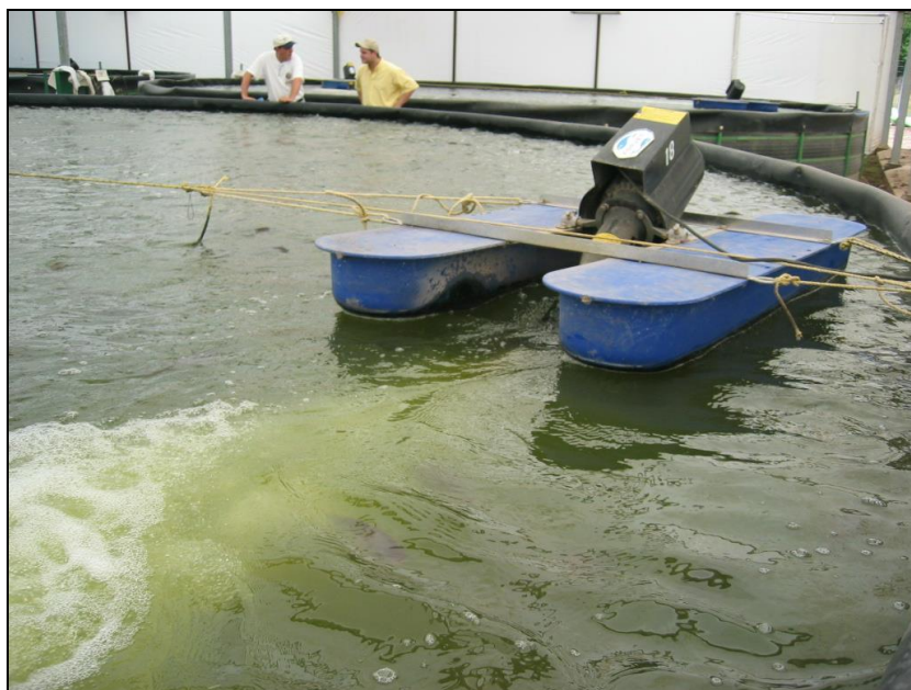
Equipos de aireación de inyección que serán colocados en cada tanque para mantener los niveles de oxígeno disuelto.
