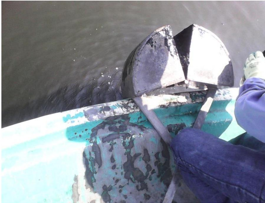
Figura IV.18. Toma de muestra de sedimento.
