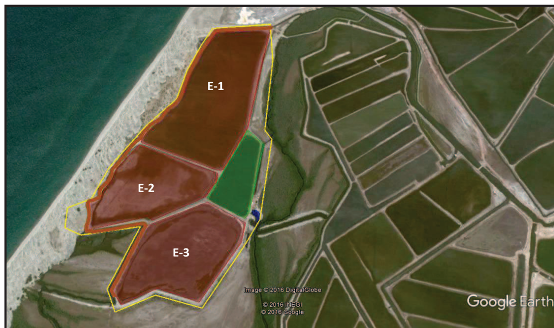
Figura II.1. Distribución de estanques (■), canal de llamada (—), reservorio (■), drenes (—) y flujo de agua (→) en la granja en operación de Acuícola Open Sea, SA de CV
