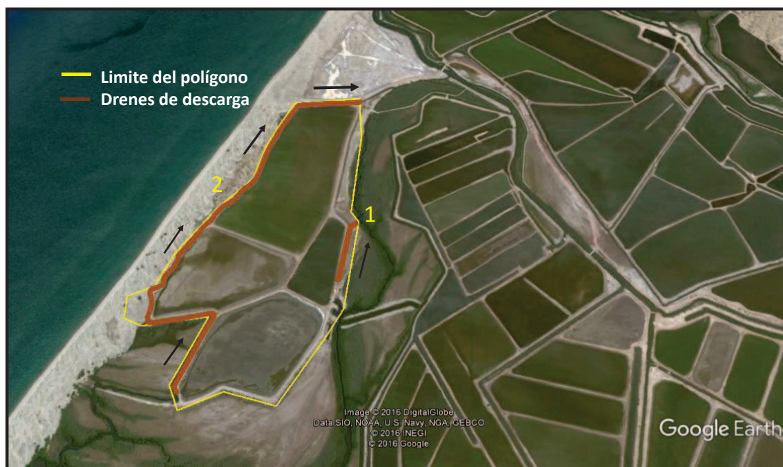
Figura II.5 Drenes con sus flujos y punto de descarga en la granja Acuícola Open Sea
