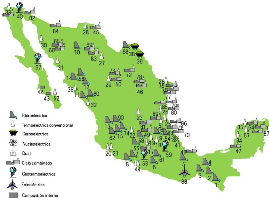
**Figura III. 3. Distribución de las principales centrales generadoras en operación.**
