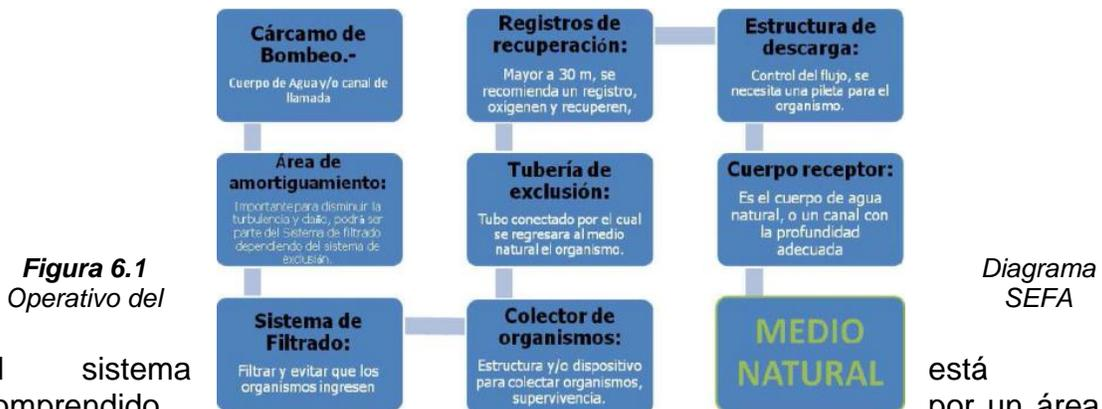
El sistema comprendido por un área de amortiguamiento, dispositivo de filtrado, colector de organismos, tubos de exclusión registros de recuperación, estructura de descarga y cuerpo receptor. está por un área de amortiguamiento, dispositivo de filtrado, colector de organismos, tubos de exclusión registros de recuperación, estructura de descarga y cuerpo receptor.
