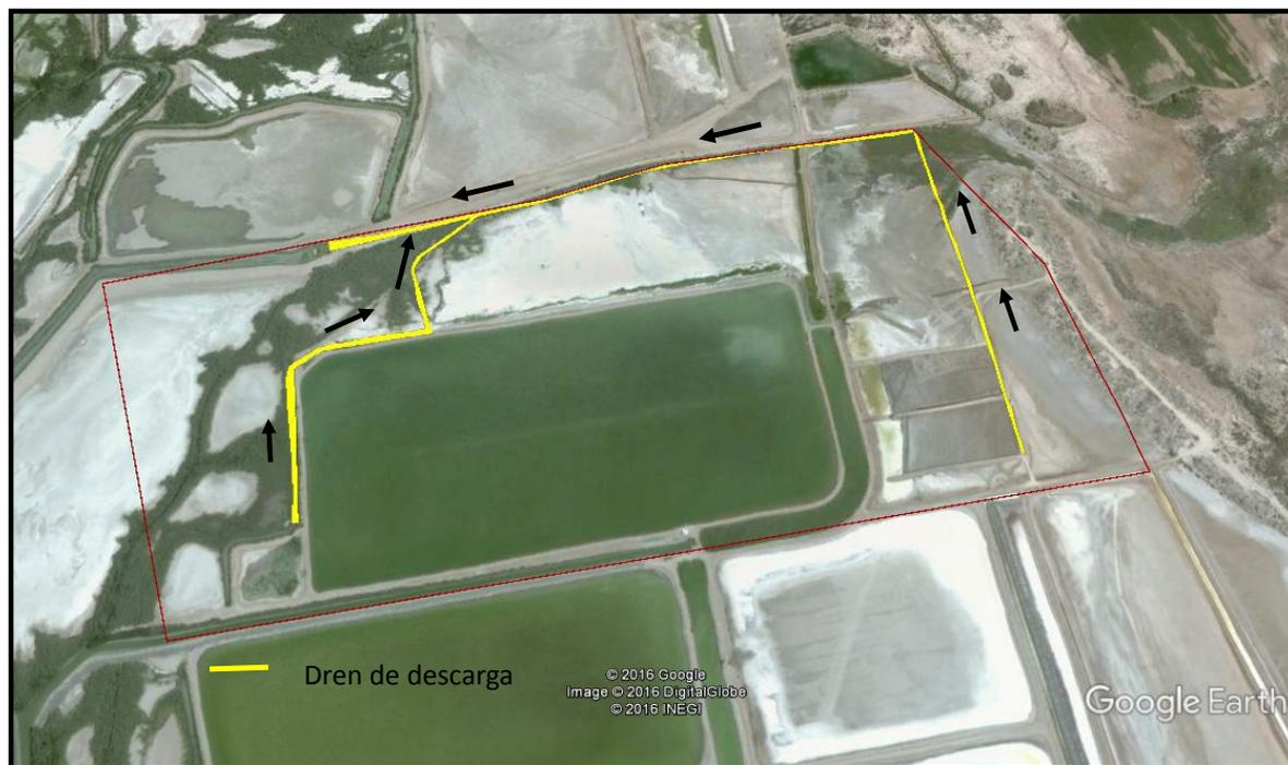
**Figura II.4.** Dren con sus flujos y puntos de descarga
