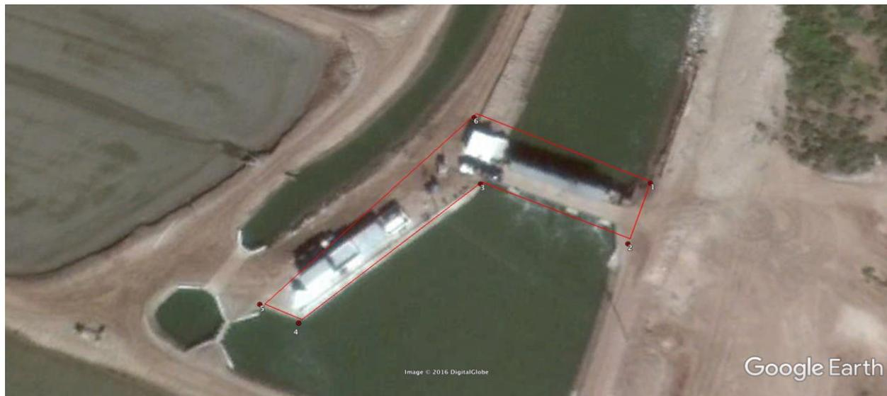
Figura 11. Imagen de satélite que muestra la ubicación de la unidad de bombeo que comparten la acuicola Santa Fe (Seccion A) y la acuicola Los 4 Hermanos a través de un reservorio de 7,775 m de longitud por 25 metros de ancho. Fuente: Google Earth.
