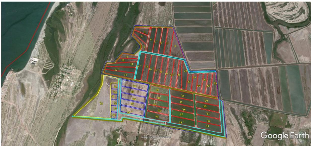
Figura 01. Infraestructura de estanquería rústica existente (polígonos rojos), infraestructura de estanquerías proyectadas (azul), canales reservorios en (color azul magenta), canales de salida ó cosecha (verde) todo dentro de la poligonal del proyecto acuicola 4 hermanos con laguna de sedimentación (poligonal en amarillo).
