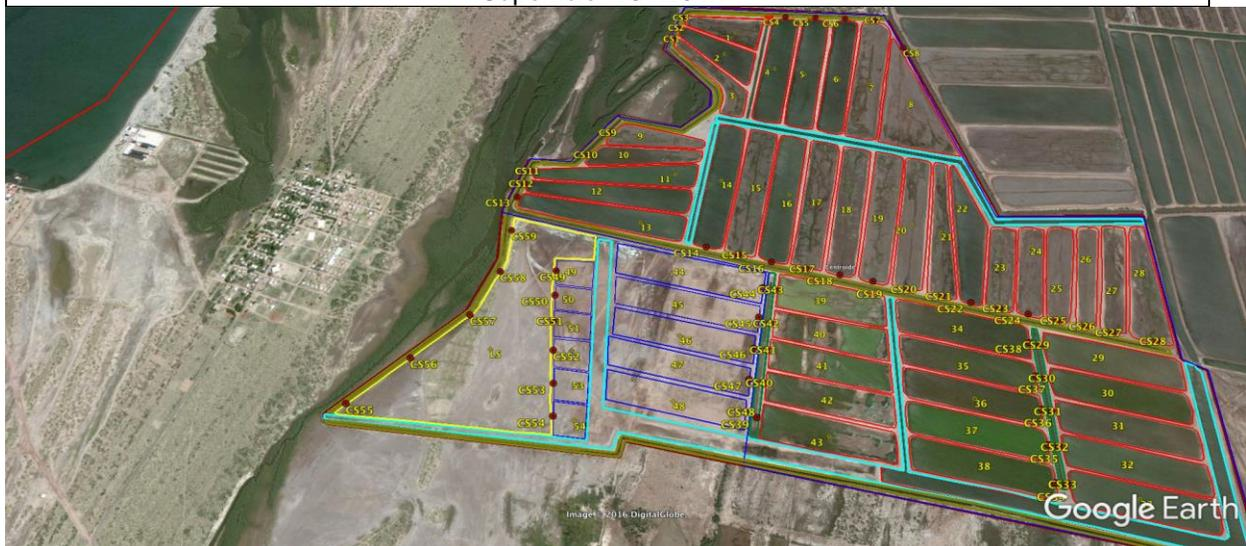
Figura 13. Distribución de las compuertas de salida a lo largo de la estanqueras de Acuícola Los 4 Hermanos, generalmente una por cada estanque (interior, en estanque; exterior, canal de salida) se incluyen compuertas en reservorios.
