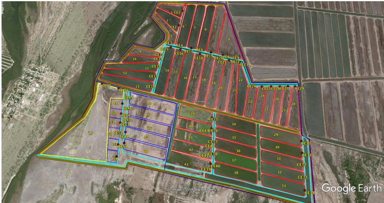
Figura 12. Distribución de Compuertas de entrada a lo largo de la estanqueras de Acuícola Los 4 Hermanos, son dos por cada estanque (interior, en estanque y exterior en reservorio) se incluyen compuertas en reservorios.
