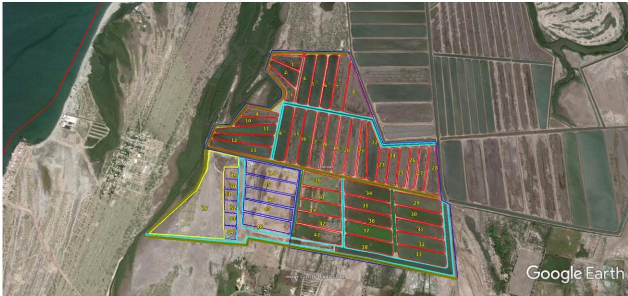
Figura 09. Infraestructura actual de granja acuícola Los 4 Hermanos al centro se observa el canal reservorio con el acomodo en cuatro módulos: 8 (1-8), 20 (9-28), 20 (29-48) y 6 (49-54) estanques a cada lado, con un total de 54 estanques, canales de aguas usadas en la periferia y el canal de llamada que abastece a la granja.
