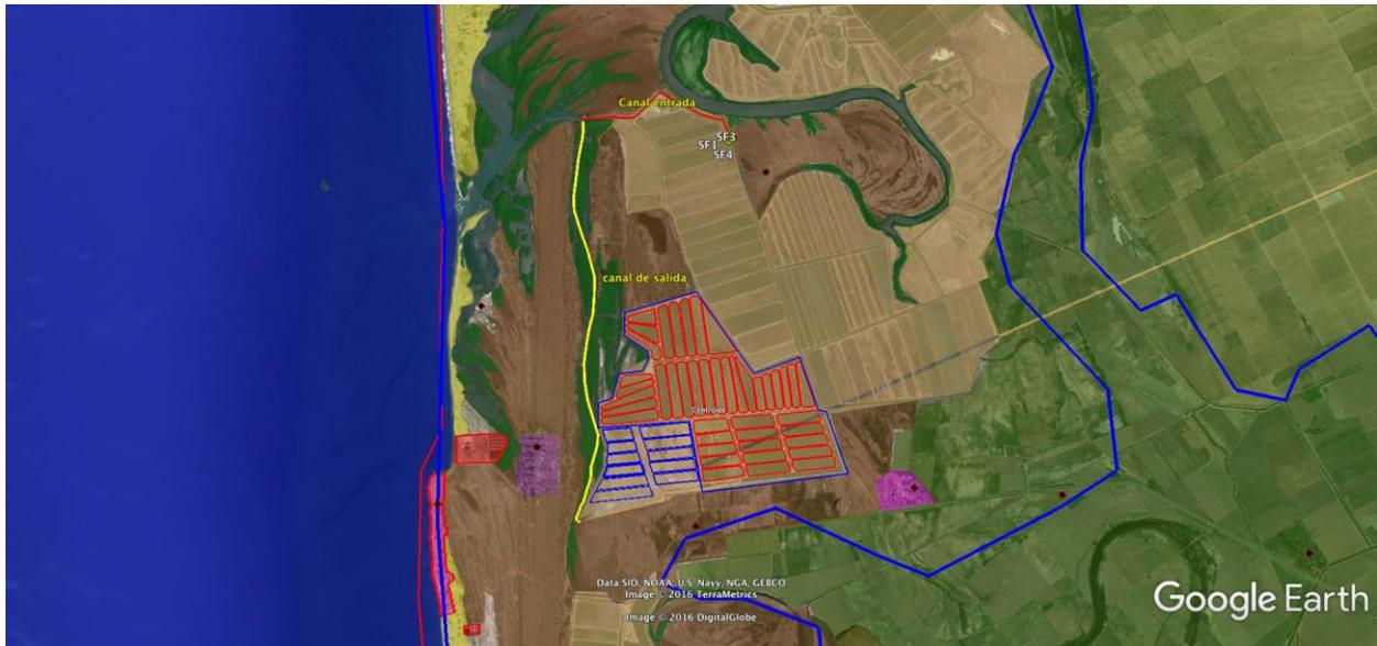
Figura 41. Dirección de las aguas usadas provenientes del sitio del proyecto, obsérvese que no sigue una trayectoria recta sino en ondulada siguiendo la trayectoria de los mangles a lo largo de 4 km hasta llegar al Estero El Manglon, en el Sistema de Esteros Las Lajitas-El Manglon al noroeste del área de proyecto.
