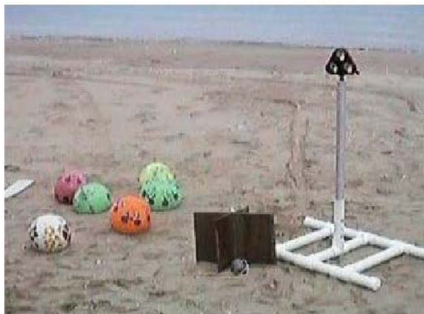
Figura 11. Pelotas de deriva utilizadas para la medición de la corriente litoral
