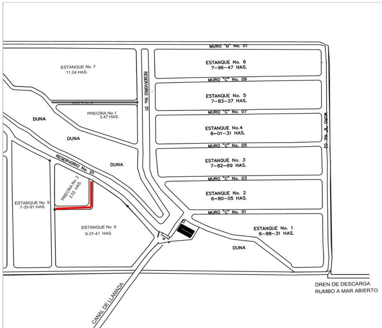
Figura 13. Formación de muro en estanque No. 8 existente para crear precría No.2 de dos hectáreas de superficie.
