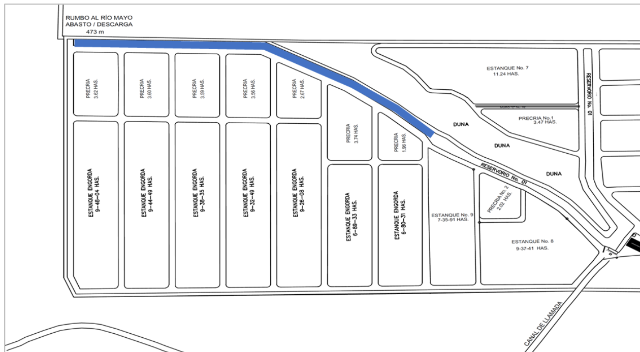
Figura 14. Ubicación (preliminar) del canal de distribución o reservorio que alimente de agua de mar a estanquería en el proyecto de ampliación y operación de granja productora de camarón en el municipio de Huatabampo, Sonora.
