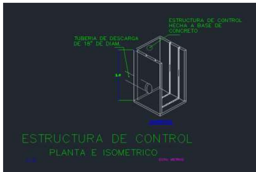
Ilustración 15. Estructura de control de los estanques rústicos.
