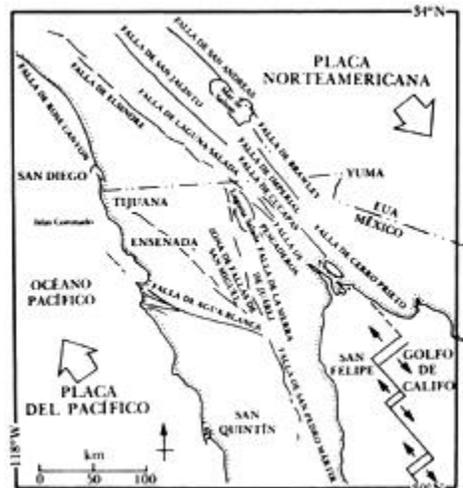
Figura 10. Principales fallas en el norte de la península de Baja California y sur de California. Los rectángulos representan zonas de dispersión (crestas). Otras zonas de dispersión unen los extremos de las fallas de Cerro Prieto e Imperial, e Imperial y Brawley.
