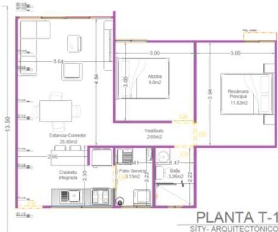
**Figura II.9** Planta arquitectónica de un departamento prototipo (T1).
