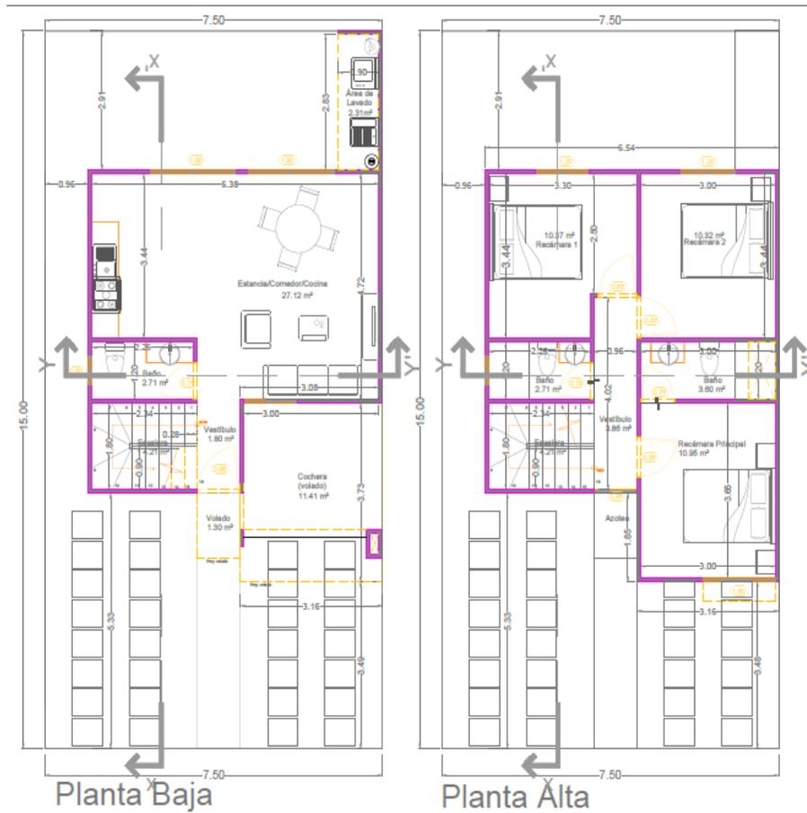
**Figura II.10** Planta arquitectónica del prototipo 1 de vivienda horizontal.
