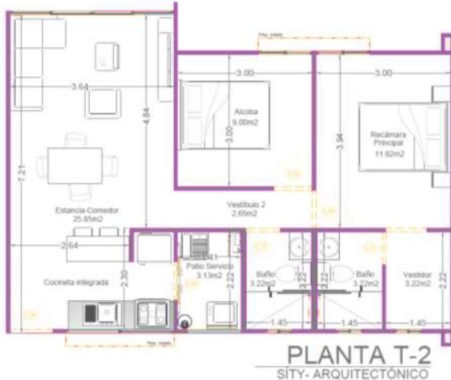
Figura II.9 Planta arquitectónica de un departamento prototipo (T2).
