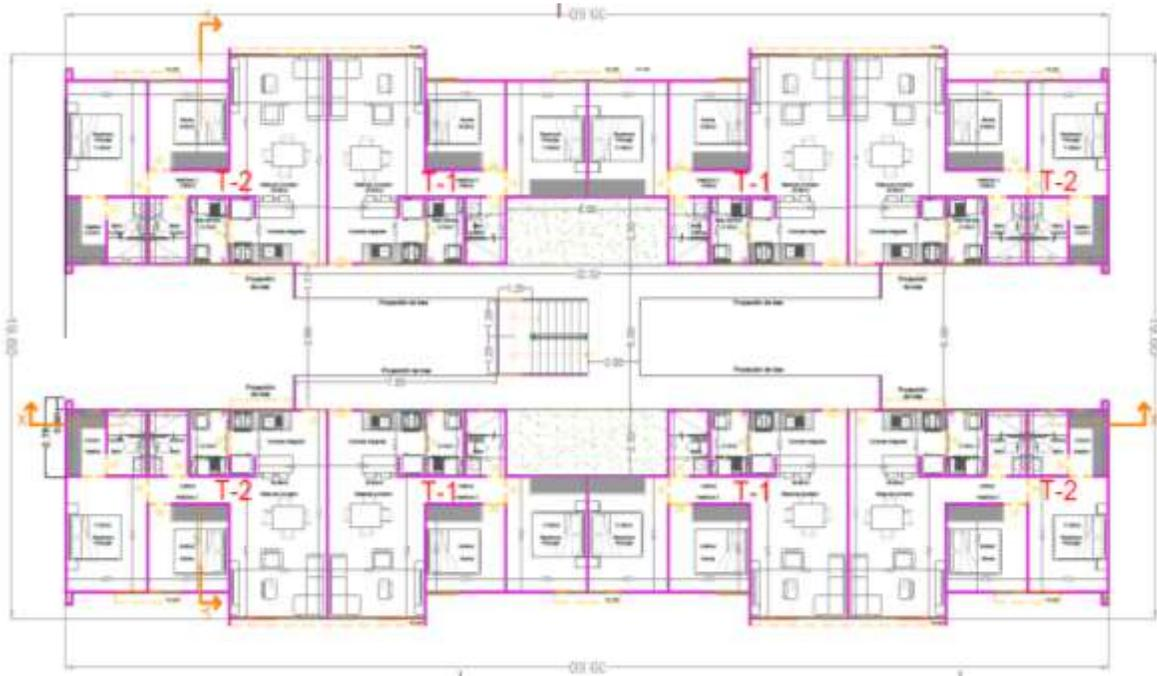
**Figura II.7** Planta arquitectónica de la planta de una torre (edificio).
