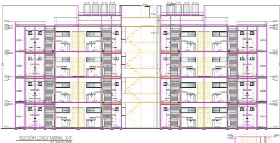
**Figura II.8** Sección longitudinal de una torre (edificio) de 4 niveles (32 departamentos).
