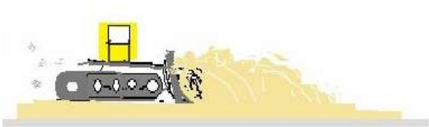
Excavación de zanjas en plataforma para la colocación de tubería de 4” con una longitud de 80 m, a una profundidad promedio de 0.40 m por 0.30 m de ancho, este trabajo se realizara de forma manual (pico y pala).
