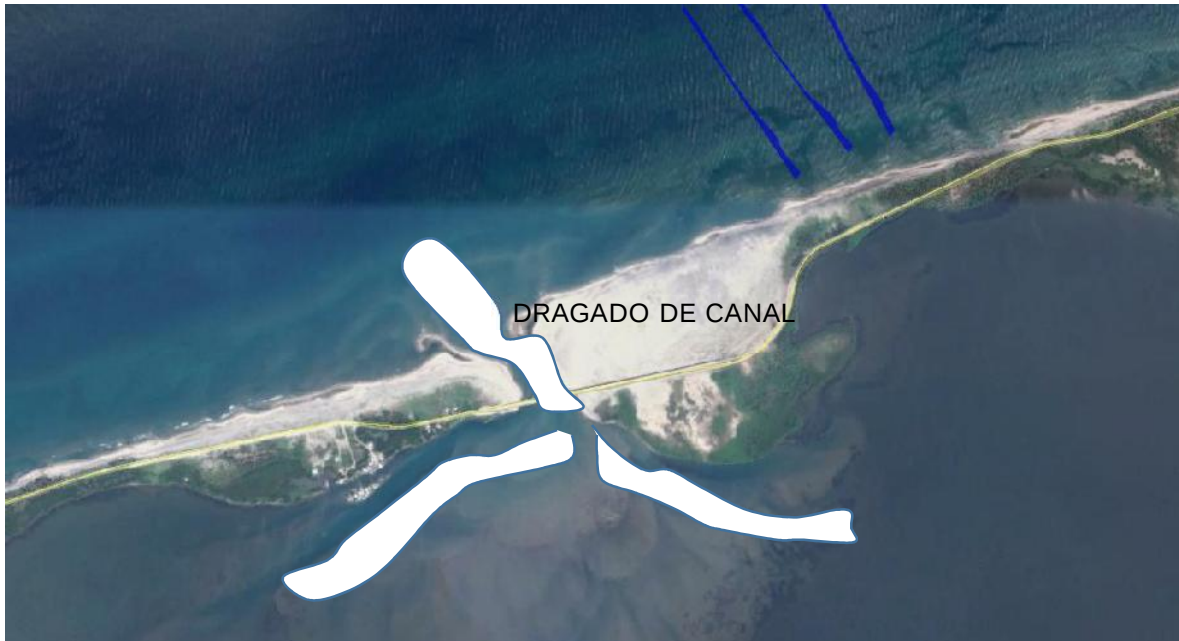
Ilustración 4 Solución propuesta para el azolvamiento en boca barra de panteones.
