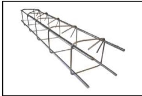
4. Una vez en el sitio, se hincaran los pilotes de (Concreto-Castillo Armex dentro de tubo de PVC) en el sitio, estos pilotes tendrán un diámetro de 6 pulgadas y un largo 6 metros, **el hincado de los pilotes variara dependiendo de la profundidad del lecho del Rio.**
