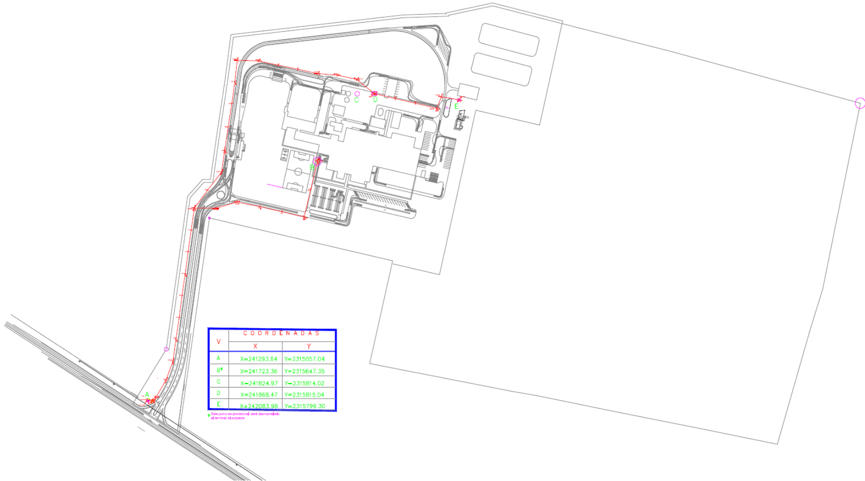
Imagen 11. Posición de los postes para la alimentación de energía eléctrica para la Planta Procesadora.
