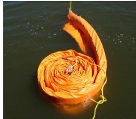
Además, se debe contar con un sistema de anclaje que mantenga la barrera desplegada en el lugar óptimo para la contención de aceite. Los sistemas incluyen anclas tipo Danforth, cuerda de nylon color amarillo, etc. Todas las anclas, cadenas, grilletes y guardacabos ojos serán de acero galvanizado, incluirá cuerda de polipropileno, boya y banderín.
