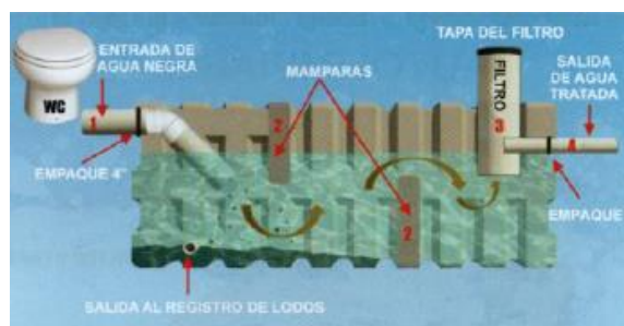
Figura II. 23. Diagrama del funcionamiento del Biodigestor
