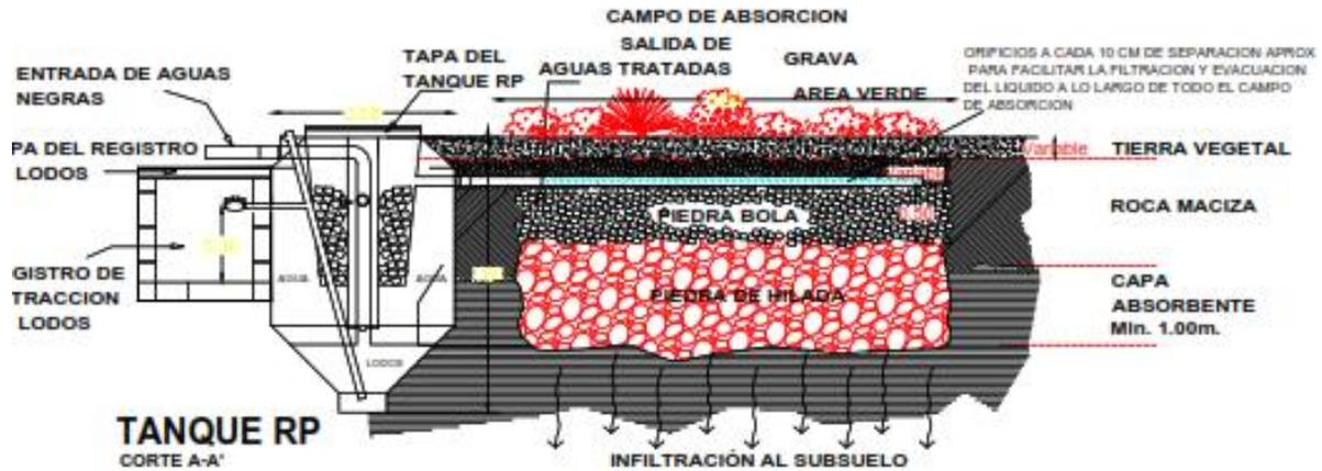
Imagen II.3. Sistema de tratamiento de agua residual a instalar.
