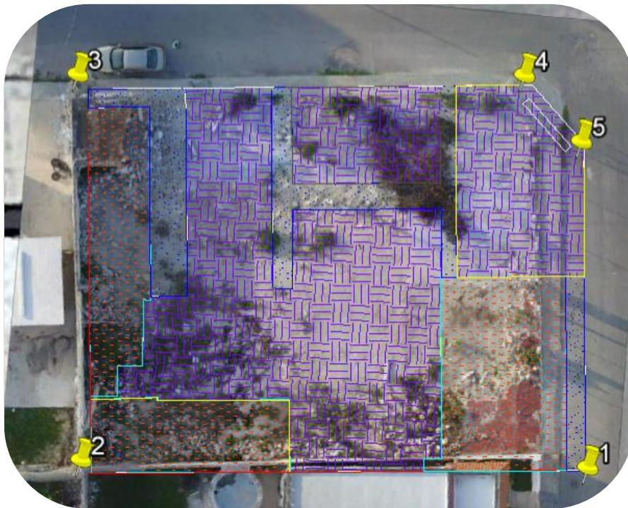
Imagen II.8. Ortomosaico generado con un dron y sobreposicionamiento de las superficies de ocupación del suelo a efectuar por el proyecto.
