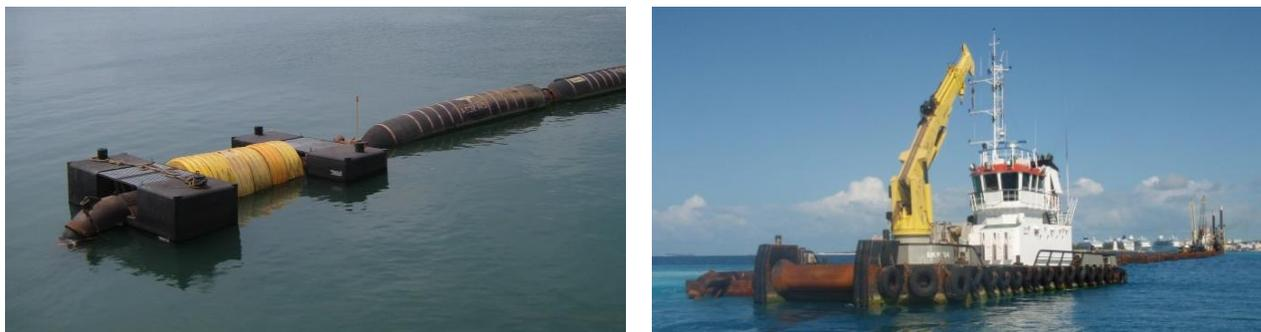
**Figura 2.26.** Pontón esparcidor con tubería de una salida (izquierda) y posicionamiento por multicat (derecha).
