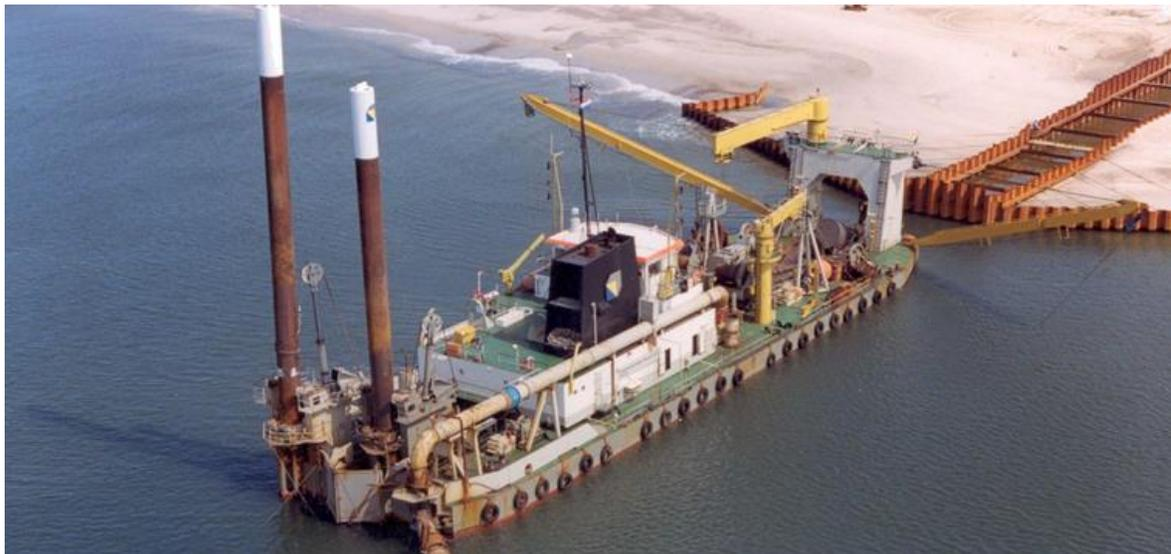
Figura 2.13. Dragas hidráulica de corte y succión.
