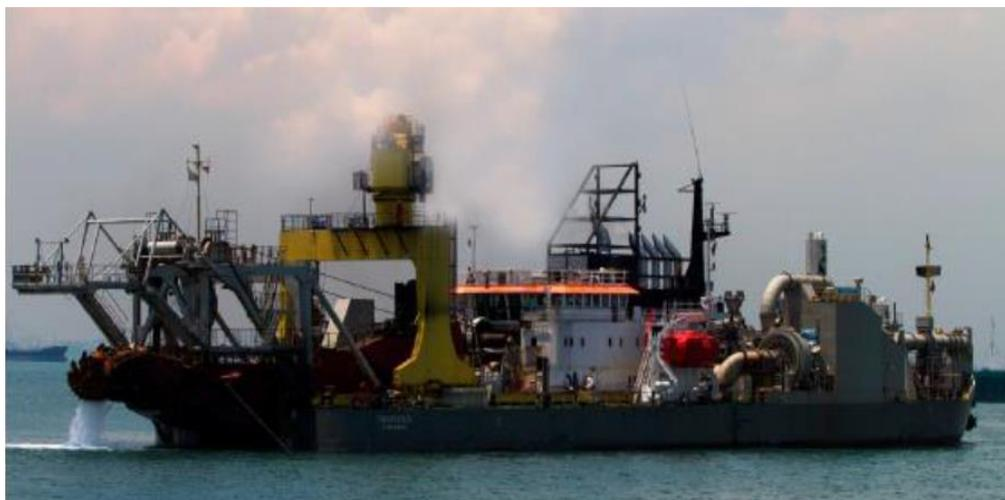
**Figura 2.16.** Dragas autopropulsada de succión de cortador.
