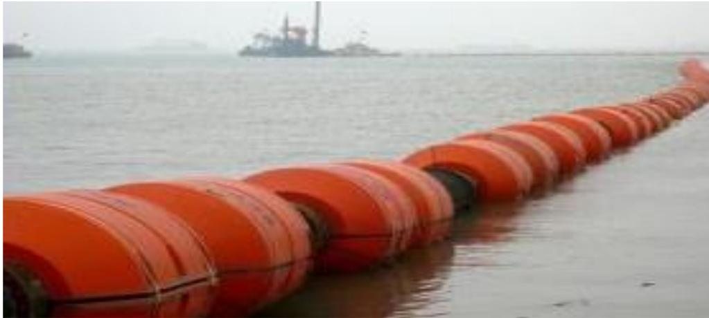
**Figura 2.28.** Tubería flotante.
