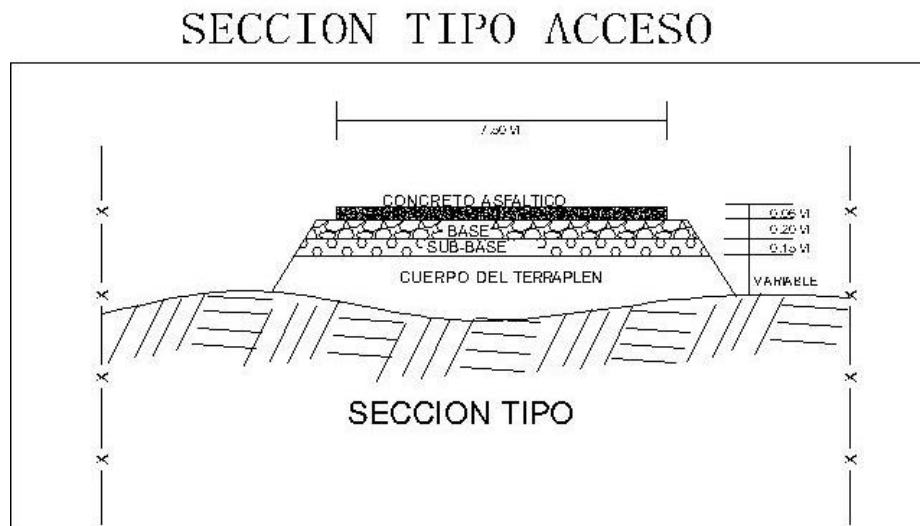
Figura 2. 4. Corte transversal de la estructura de terraplén para el camino de acceso
