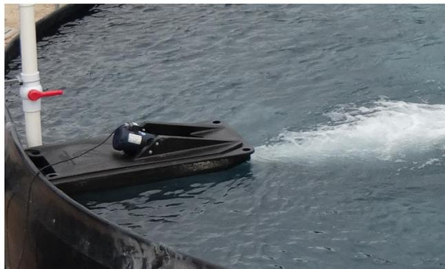
Ilustración 19.-Aireador en funcionamiento en un tanque de geomembrana.
